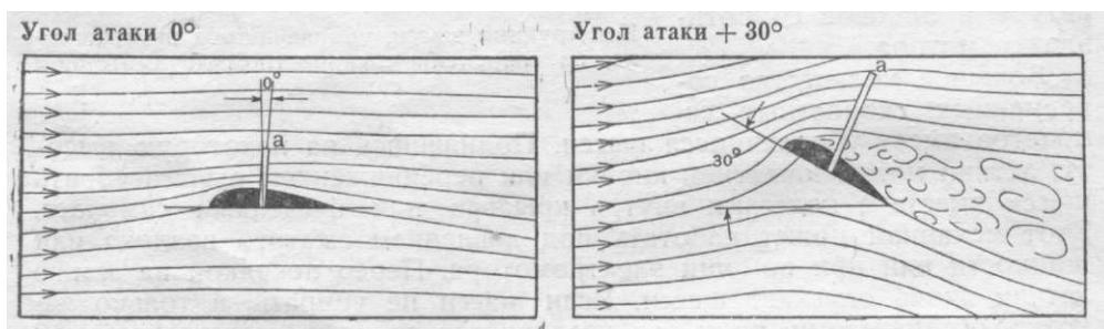
Наиболее плотное обтекание потоком воздуха. Подъемная сила имеется, несмотря на нулевой угол атаки
