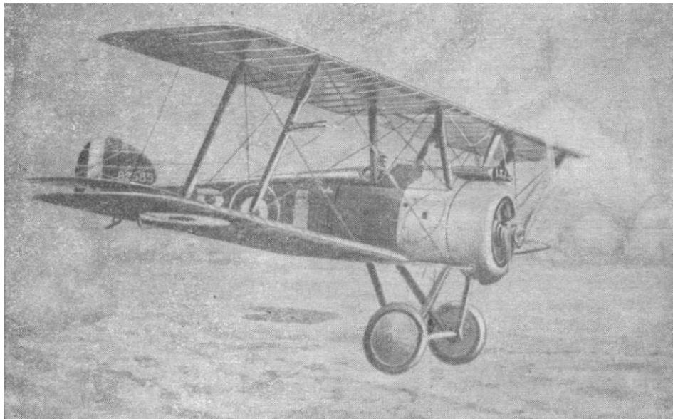
Английский истребитель времен войны 1914—1918 гг. «Сопвич-Кэмел» с мотором «Клержэ» в 130 лошадиных сил. Размах крыльев — 8,4 метра, длина самолета — 5,6 метра, полетный вес — 670 килограммов, максимальная скорость — 194 километра в час, скороподъемность на 3000 метров — 8,3 минуты, потолок — 6900 метров.
