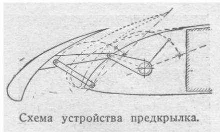
Схема устройства предкрылка.
