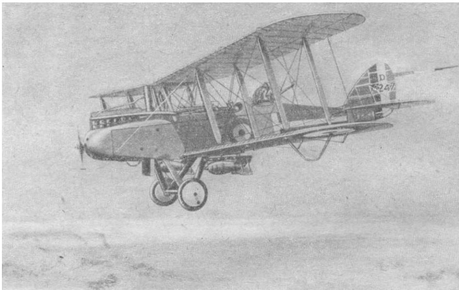
Английский бомбардировщик «Дейч-Найн» (ДН-9), появившийся к концу войны 1914—1918 гг., с мотором «Сидлей Пума» в 230 лошадиных сил. Максимальная скорость—180 километров в час, скороподъемность на 3000 метров —17 минут; с более мощным мотором скорость возросла до 220 километров в час, а скороподъемность на 3000 метров дошла до 8 минут.
