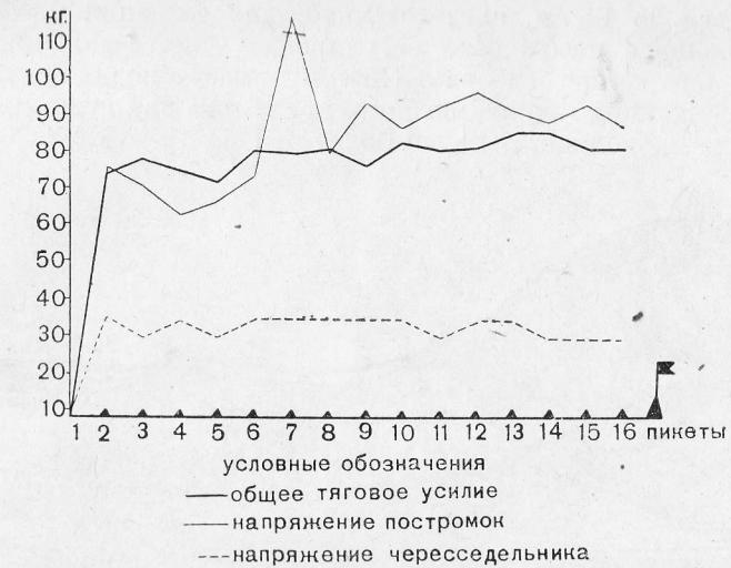
Рис. 19. Работа деталей бездуговой упряжи.
