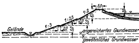
Abb. 8. Kanal im Auftrag.
