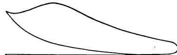
Fig. 128. Indikatordiagramm einer Verbrennungsmaschine (Explosionsmotor) mit stark verspäteter Zündung oder sehr schlechtem Gemisch.
