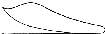
Fig. 134. Indikatordiagramm einer Verbrennungsmaschine (Explosionsmotor) mit stark verspäteter Zündung oder sehr schlechtem Gemisch.
