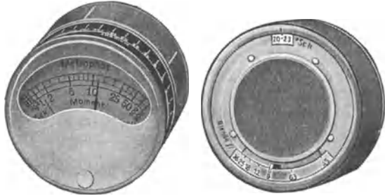
Abb. 137. Belichtungsmesser Metraphot (Metrawatt).
