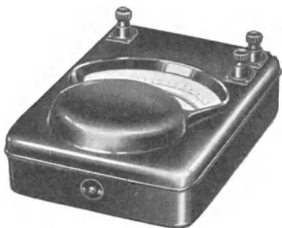
Abb. 34. Drehspulinstrument Klasse E (S. & H.).
