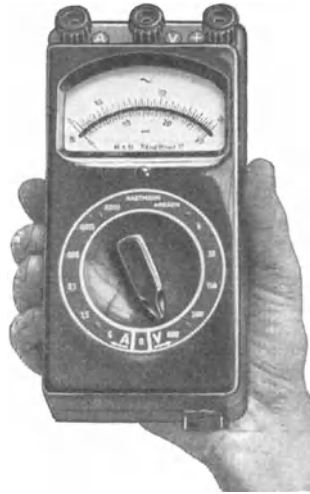
Abb. 36. Drehspulinstrument Multavi II (Hartmann & Braun).
