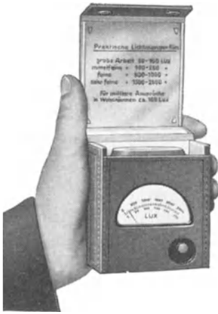
Abb. 119. Beleuchtungsmesser Parvux (Gossen).
