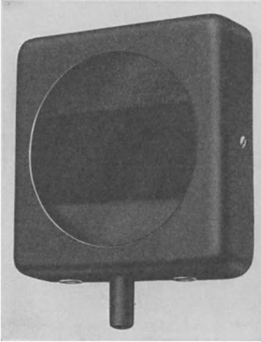
Abb. 77. Sperrschichtphotoelement mit Dreslerschem Filtersatz (Bercowitz).
