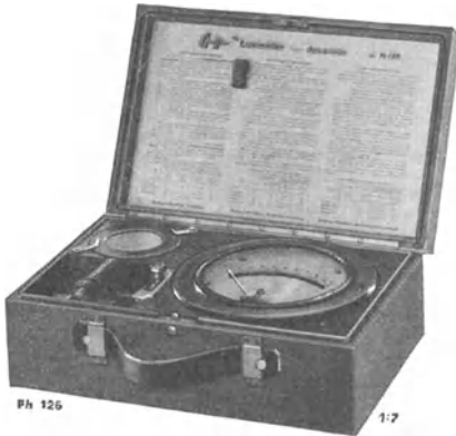
Abb. 121. Beleuchtungsmesser Galvanolux (Pfeiffer).
