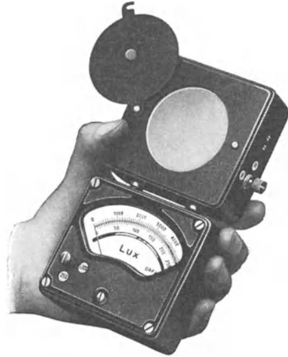
Abb. 120. Beleuchtungsmesser Tavolux (Metrawatt).
