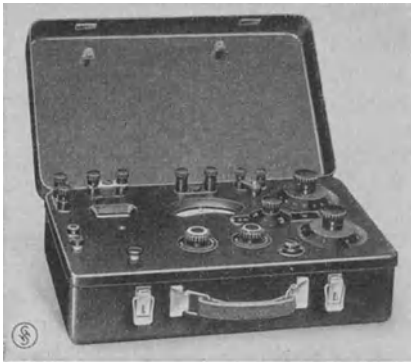
Abb. 50. Technischer Kompensator (S. & H.).
