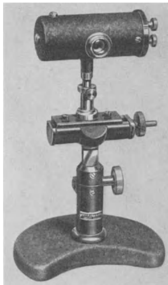
Abb. 1. Vakuum-Thermoelement nach Moll (Kipp).
