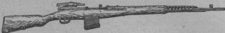
Фиг. 455. Снайперская 7,62-мм винтовка обр. 1940 г.
