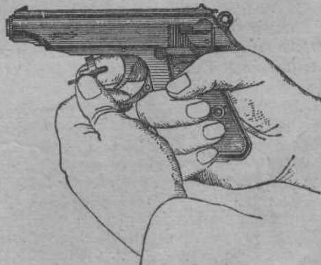
Фиг. 330. Отделение кожуха-затвора.
