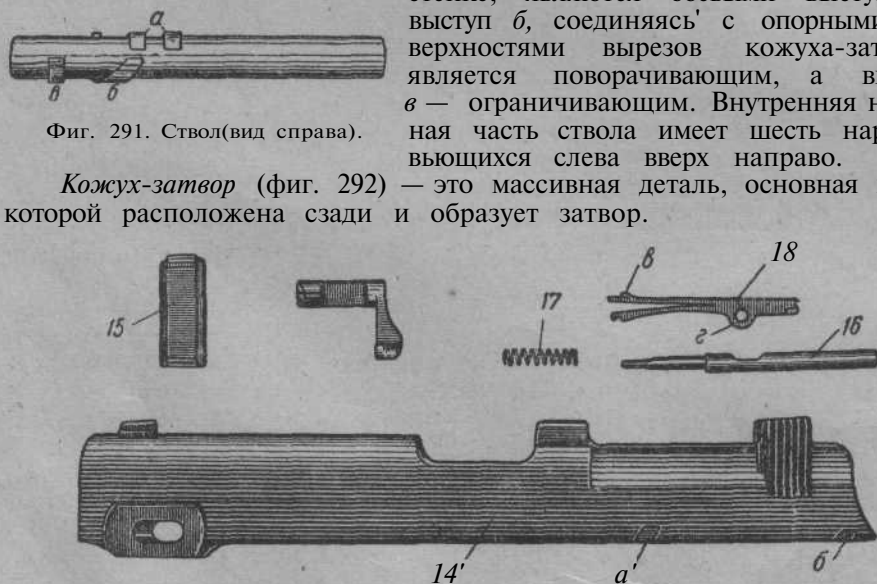
Фиг. 291. Ствол (вид справа). Фиг. 292. Кожух-затвор. 14 — кожух-затвор, 15 — соединительная чека, 16 — ударник, 17 — пружина ударника, 18 — выбрасыватель.
