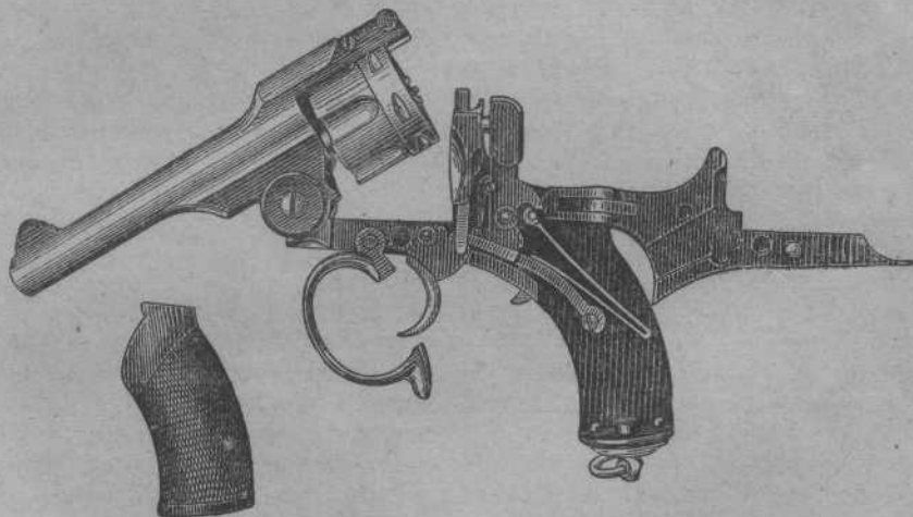
Фиг. 221. Японский револьвер Хино (положение для разборки).
