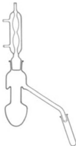
Abb. 7. Mikrodestillationsapparat, modifiziert nach GAWALOWSKI. \frac{1}{2} der nat. Gr. Das Abflußrohr \frac{1}{3} der nat. Länge.
