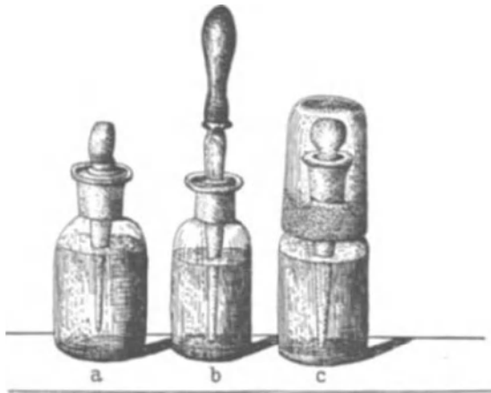
Abb. 1 a–c. Stöfffläschchen. \frac{1}{2} der natürlichen Größe. a mit solidem Glasstift. b ebenso mit Glaskappe. c mit Glasrohr und Kautschukkappe.
