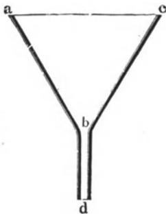
Abb. 86. Trichter von 60° Spannung mit richtig gebautem Ablauf *b d*.
