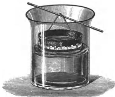
Abb. 105. Dialysiervorrichtung.
