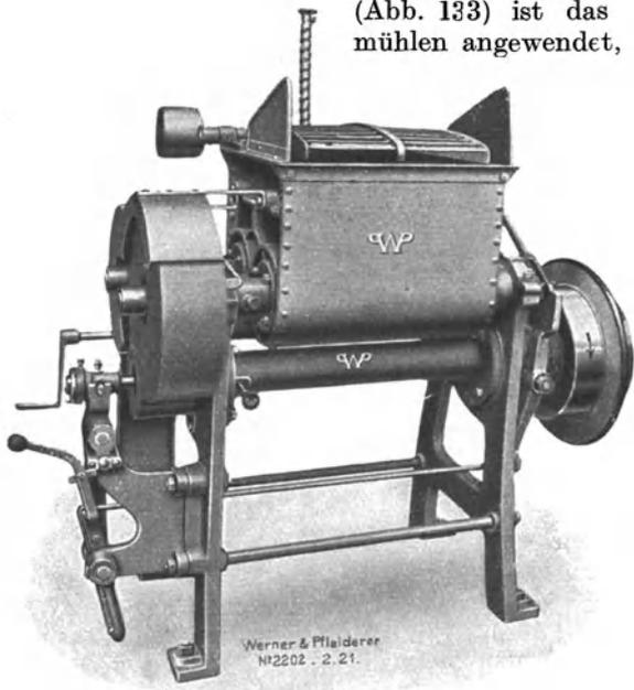
Abb. 131. Salbenmisch- und -knetmaschine.
