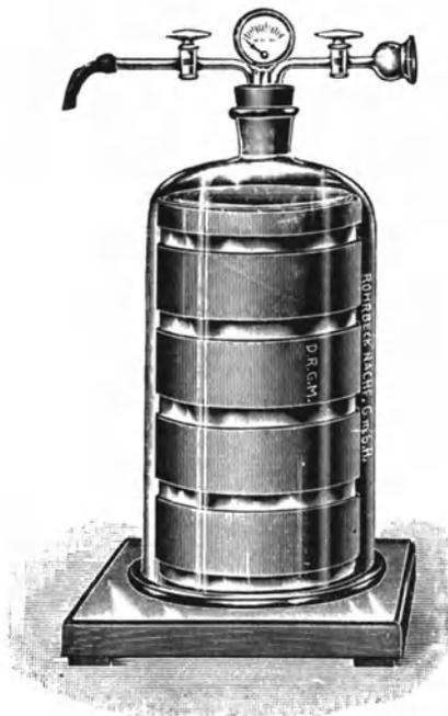
Abb. 52. Moderner Ampullenfüllapparat.
