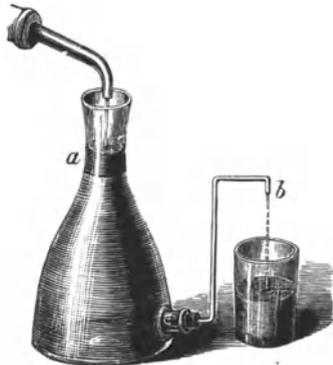
Abb. 111. Florentiner Flasche. Bei *a* sammelt sich das ätherische Öl, bei *b* fließt das Wasser ab.
