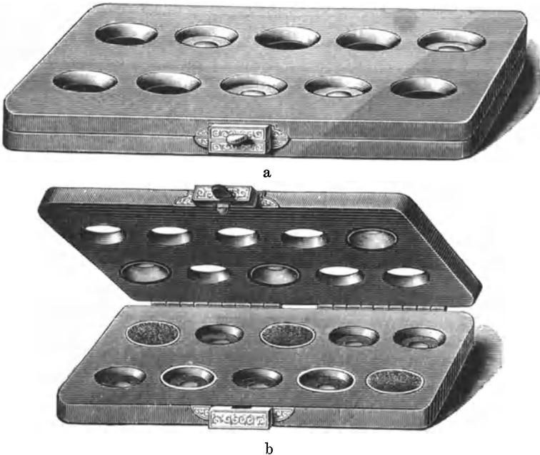
Abb. 16 a/b. Älterer Stärkekapselapparat offen und geschlossen.
