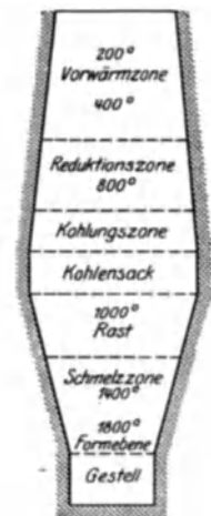
Abb. 74. Eisenhochofen, Schema.
