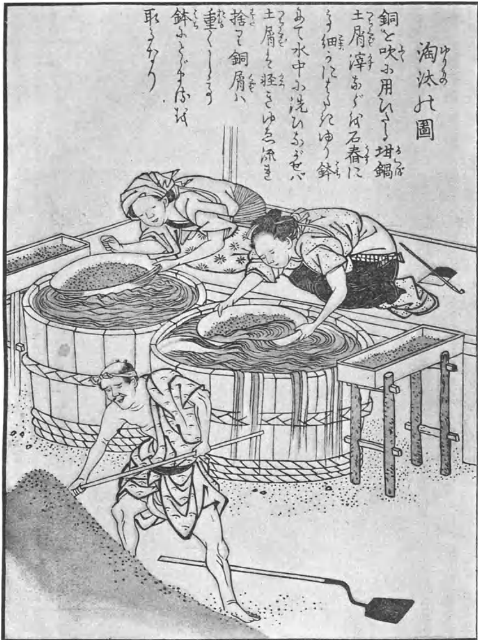
213. Waschen des Kupfererzes in Schalen zu Beschi in Japan. Nach einem älteren japanischen Werte.
