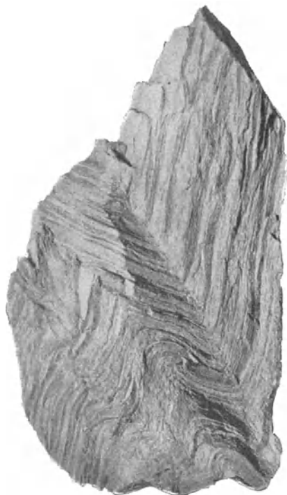
43. Schichtenbiegung und Knickung des Thonschiefers.
