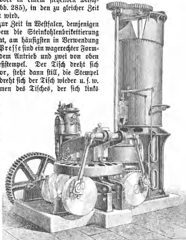
285. Steinkohlenbrikettpreße mit doppelter Pressung. System Couffinhall. (Bauart Schächtermann & Kremer, Dortmund.)
