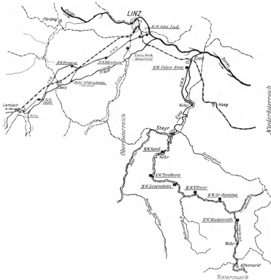
Abb. 15. Traun- und Enns-(Laufwerks-)Projekte der ÖKA; Übersichtskarte, Maßstab 1 : 600 000
