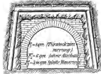
Abb. 518. Streckenquerschnitte mit gleichem Widerstande für den Durchzug der Luft.
