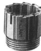
Abb. 104. Bohrkrone mit Hartmetallprismen.
