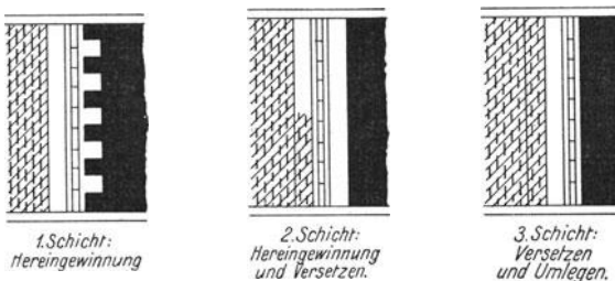
Abb. 376. Arbeitsverlauf bei täglichem Umlegen und Kohलगewinnung während 2 Schichten.
