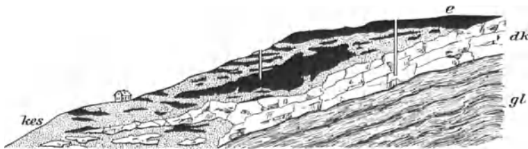
Abb. 39. Eisenerz-Lager und -Nester auf Elba (epigenetisch). Nach Fabri. e Erz, dk dolomitischer Kalkstein, gl Glimmerschiefer, kes Kalk-Eisen-Silikatgestein.
