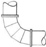
Abb. 574. Luttenkrümmer aus einzelnen zusammengelödeten, geraden Stücken bestehend.
