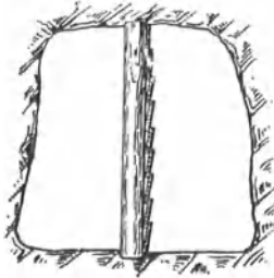
Abb. 564. Hölzerner Wetterscheider in Schuppenanordnung.
