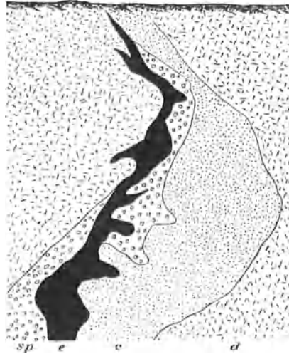
Abb. 42. Kupfererzstock von Monte Catini in Toskana (syngenetisch). Nach G. vom Rath. e Erz, sp Serpentin, c Konglomerat, d Diabas.
