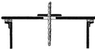
Abb. 543. Schachtdeckel mit kleinerem Deckel für das Seilloch.
