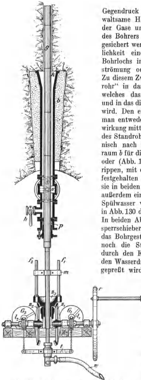
Abb. 130. Anbohren eines erschoffenen Schachtes.
