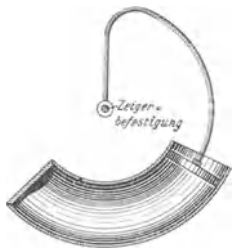
Fig. 439. Luftdämpfung bei Meßinstrumenten.
