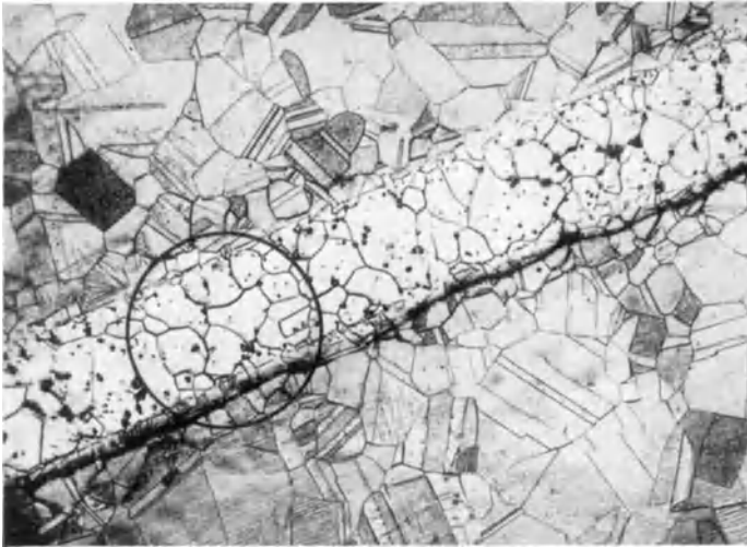
Abb. 14. Einwandfreie Lötstufe mit inniger Vereinigung von Lot und Werkstück.
