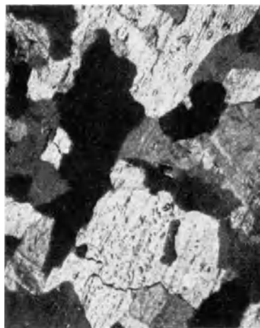
Abb. 4. Werkstück wie Abb. 1, jedoch Glühdauer 5 Stunden (Vergr. 50 ×).
