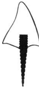
Abb. 3. Porzellanmassivkrone mit eingebrauntem Wurzelstift aus Platin-Iridium.
