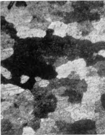
Abb. 7. Gewalztes Platin. 10 Minuten bei 900° geglüht (Vergr. 50 ×).
