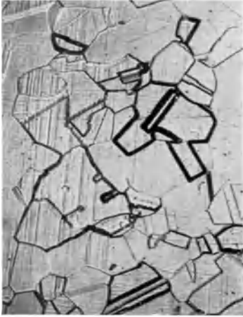
Weicher Zustand. Härte 105 Brinell.
