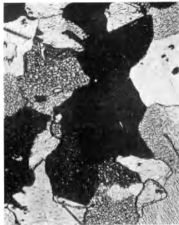
Abb. 8. Gewalztes Platin. 10 Minuten bei 1000° geglüht (Vergr. 50 ×).
