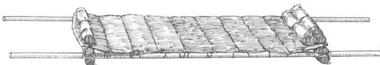
Abb. 177. Nottrage, aus Holzstämmchen, Strohmatten und Strohekien.
