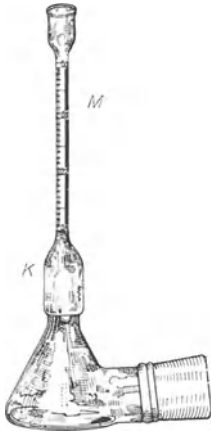
Abb. 385. Auffanggefäß für das ätherische Öl [KOFLER]. Die mit dem Kolben durch Schliff verbundene Kappe K trägt die angeschmolzene Meßcapillare M (Verkl. \frac{1}{4,5} ).
