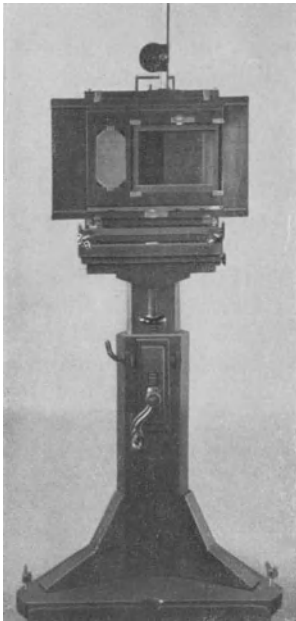
Abb. 13. Photographische Kamera von hinten mit einem Rahmen, der eine dreiteilige Aufnahme gestattet, \frac{1}{18} n. Gr.
