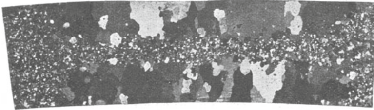
Durch metallographische Methoden sichtbar gemachte Aktivitätszone eines um den Radius 90 cm gebogenen Zinnstreifens ( 7/10 nat. Gr.).
