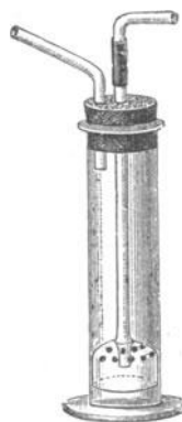
Fig. 33. Waschflasche nach Drehschmidt.
