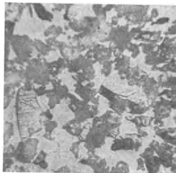
Fig. 74. Quarzteile, welche zu 74 \times Korrosionen einer Welle Veranlassung gaben.
