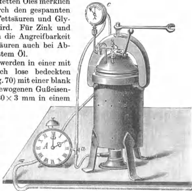
Fig. 71. Autoklav mit selbsttätiger Abstellung der Gaszufuhr und automatischer Druckeinstellung.
