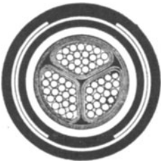
Abb. 64. Verschiedene Kabelausführungen NKBA für Spannungen bis 1000 V.
