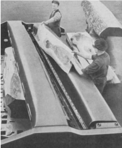
Abb. 1. Messermaschine im Betrieb, von oben gesehen (Firma Vereinigte Furnier- und Sperrholzmaschinenfabriken, Berlin, im folgenden nur mit RFR bezeichnet).
