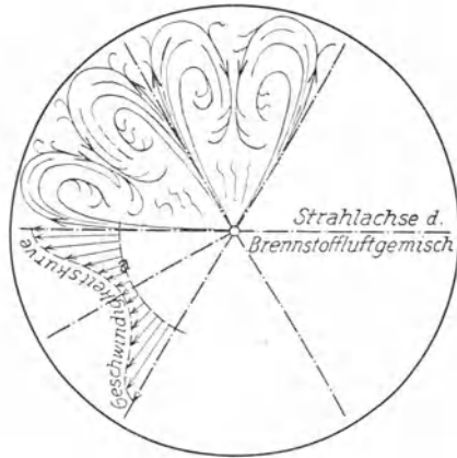
Abb. 20. Schnitt durch den Verbrennungsraum normal zur Zylinderachse (schematisch) während des Einblasevorganges (Mehrlochdüse).
