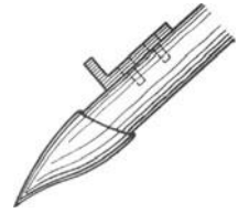
Abb. 125. Stativfuß mit Eisenschuh und Trittansatz.
