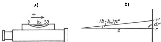
Abb. 241 a und b. Nivellieren mit schwach geneigter Sicht.
