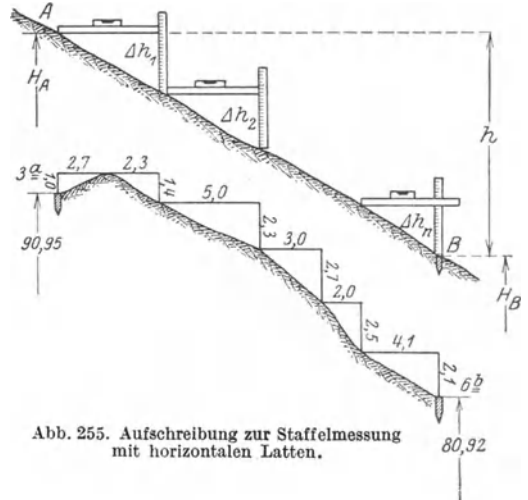
Abb. 254. Staffelmessung mit horizontalen Latten.
