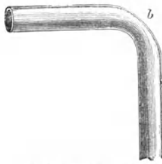
Abb. 54. Zu rasch gebogene Glasröhre.
