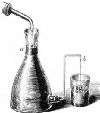
Abb. 111. Florentiner Flasche. Bei a sammelt sich das ätherische Öl, bei b fließt das Wasser ab.
