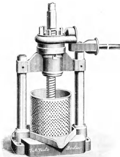
Abb. 141. Differentialhebelpresse, deren Hebel im Halbkreis hin und her bewegt wird.
