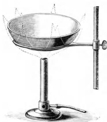
Abb. 63. Übermäßig brennender Bunsenbrenner.
