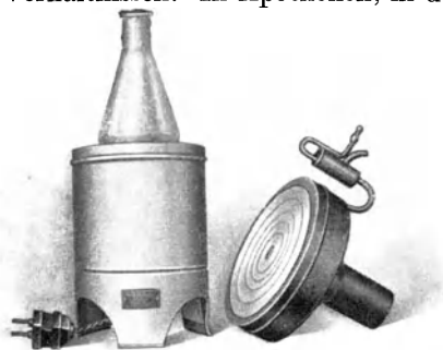
Abb. 68. Elektrischer Kocher und elektrisch geheiztes Wasserbad.
