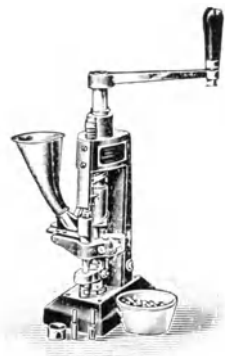
Abb. 31. Tabletten-Komprimiermaschine „Triumph“ von F. Kilian.
