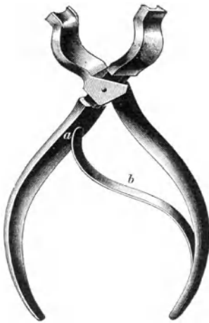
Abb. 157. Korkzange. a b Feder, welche sie auseinanderhält.
