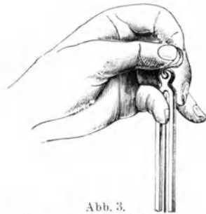
Abb. 3. Haltung der Hand bei Anwendung der Handwagen.
