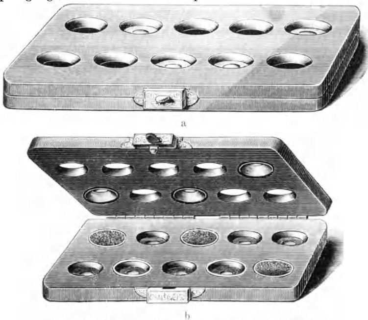
Abb. 16a b. Älterer Stärkekapselapparat offen und geschlossen.
