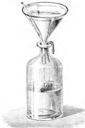
Abb. 99. Filtration mit eingehängtem Bindfaden und unter das Filter geschobenem Glasstab, um die Luft aus der Flasche zu lassen.
