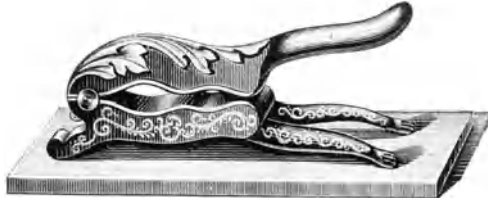
Abb. 156. Korkpresse aus Gußeisen.
