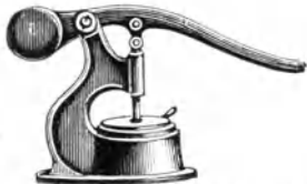
Abb. 26. Pastilleurpresse von Hennig & Martin, sehr verkleinerter Maßstab.
