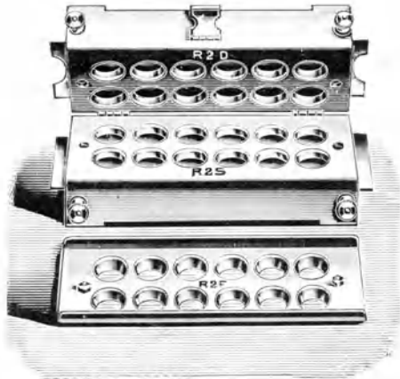
Abb. 17. Neuerer Stärkekapselverschlußapparat. (Vereinigte Lausitzer Glaswerke A.-G.)
