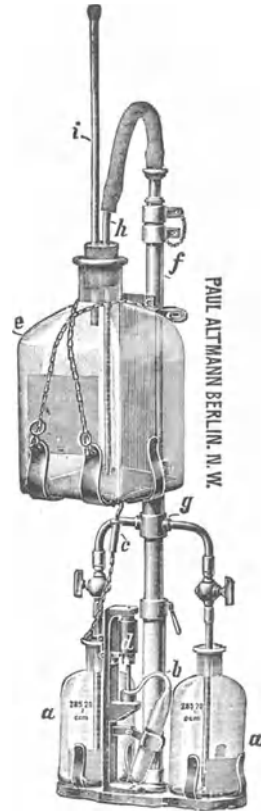
Abb. 20. Wasserentnahmeapparat nach SPITTA-IMHOFF.
