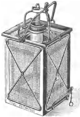
Abb. 2. Wasserentnahmeapparat nach HEYROTH.
