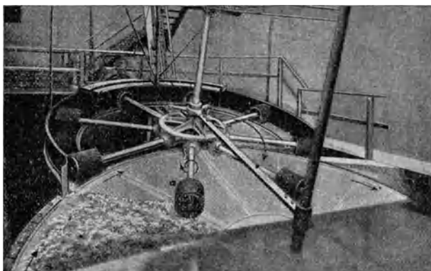
Separatorscheibe System Riensch. Die Hauptteile der Anlage sind zu erkennen. Durchmesser der Scheibe 4,5 m; Schlitze 2 mm breit, 30 mm lang.
