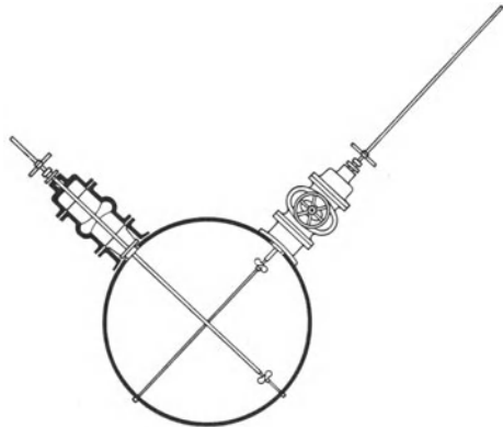
Abb. 159. Einrichtung für Flügelmessung in einer Turbinenleitung. Fa. Ott.
