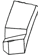
Fig. 543. Auf Grauguß abgenutzte Schneide.
