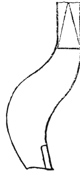
Fig. 396. Nutenstahl mit aufgeschweißtem Schnellstahl.
