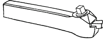
Fig. 199. Gerader Halter mit geradem Einsatzstahl.
