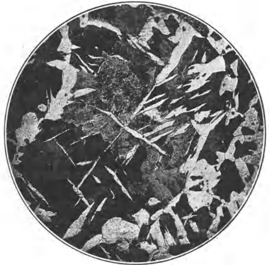
Fig. 202. Stahlguß mit 0,4% C, bei 100° gegläht, Ätzung II, x 100.
