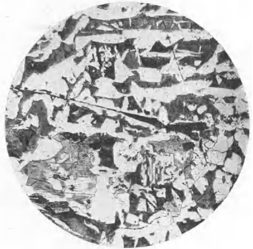
Fig. 245. Oxydreste am Ausläufer des Risses, Ätzung II, \times 100 .
