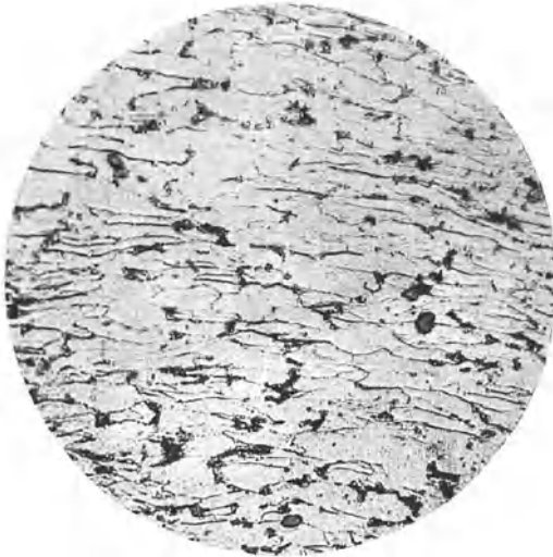
Fig. 215. Gezogene Zone eines um 180° gebogenen Stabes aus weichem Flußeisen, Ätzung II, x 100.
