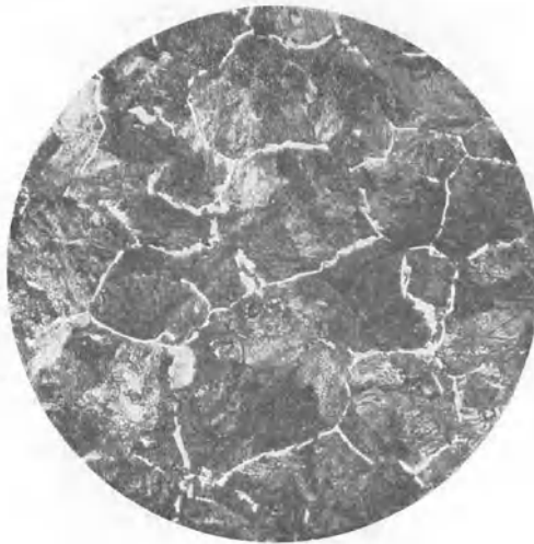
Fig. 22. Eisen-Kohlenstoff-Legierung mit 0,64% C, Ätzung II, x 100.
