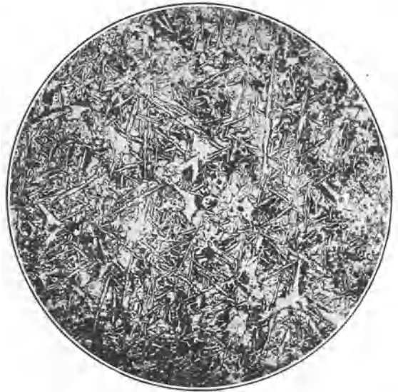
Fig. 200. Stahlguß mit 0,4% C, bei 730° gegläht, Ätzung II, x 100.
