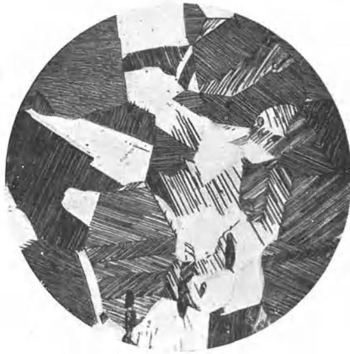
Fig. 309. Wie Fig. 307. jedoch \frac{1}{2} Stunde bei 1000^{\circ} geglüht und abgeschreckt, \times 250 .
