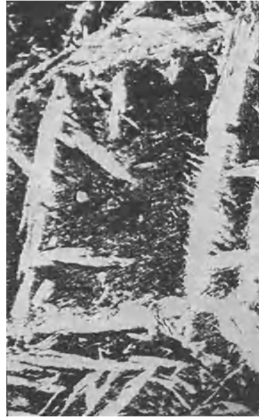
Fig. 317. Wie Fig. 315, jedoch auf 150° angelassen (Maurer), Ätzung II x400.
