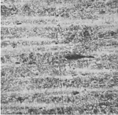
Fig. 298. Dasselbe Stück wie Fig. 296, auf 1250^{\circ} erhitzt, an der Luft abgekühlt, Ätzung I, x 50.
