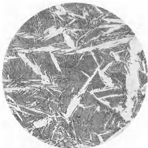
Fig. 27. Gemisch von Austenit (dunkel) — Martensit (hell), Ätzung II, x 200.
