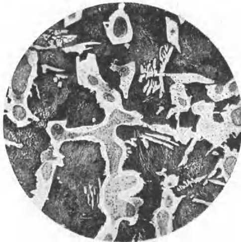
Fig. 141. Legierung mit 0,2% C und 0,6% P, ungleichmäßige Verteilung des Phosphors (Kristallseigerung), x 100.
