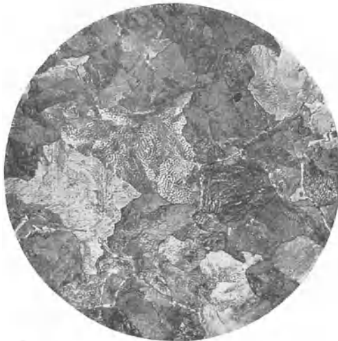
Fig. 30. Sorbit mit feinlamellarem Perlit, Ätzung II, x 300.
