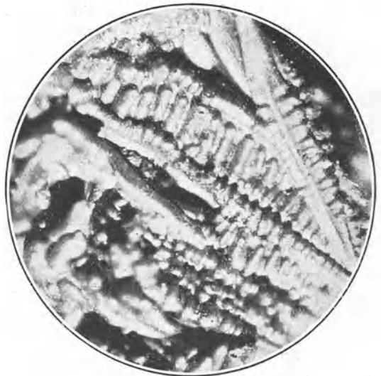
Fig. 174. Bruch des Zerreißstabes Fig. 173 mit Dendriten, x 4.
