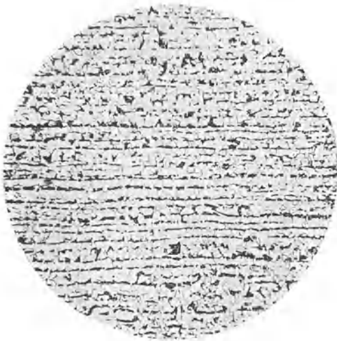
Fig. 275. Sekundäre, Zeilenstruktur, Ätzung II, x 50.
