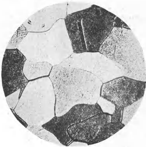
Fig. 212. Zwilling in deformiertem \alpha -Eisen. x 100.
