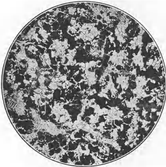
Fig. 201. Stahlguß mit 0,4% C, bei 800° gegläht, Ätzung II, x 100.
