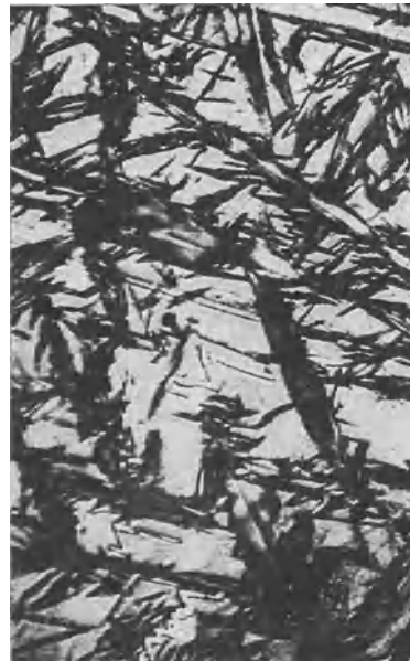
Fig. 316. Wie Fig. 315, jedoch auf 150^{\circ} angelassen, Ätzung II, \times 400 . (Maurer.)
