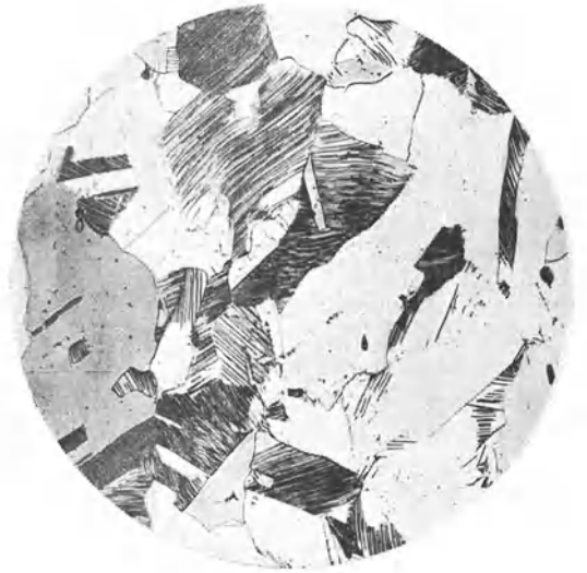
Fig. 308. Wie Fig. 307, jedoch 1/2 Stunde bei 1000° geglüht und langsam abgekühlt, x 250.
