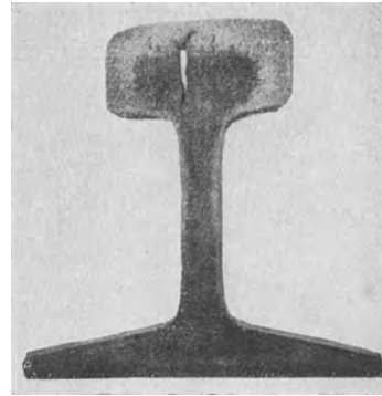
Fig. 241. Schiene mit unvollständig zusammengeschweißtem und durch das Befahren wiederaufgequetschtem Lunker.
