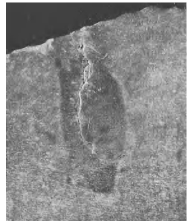
Fig. 340. Stärkere Vergrößerung einer Phosphoransammlung aus Fig. 339 mit Riß. Ätzung I x 10.
