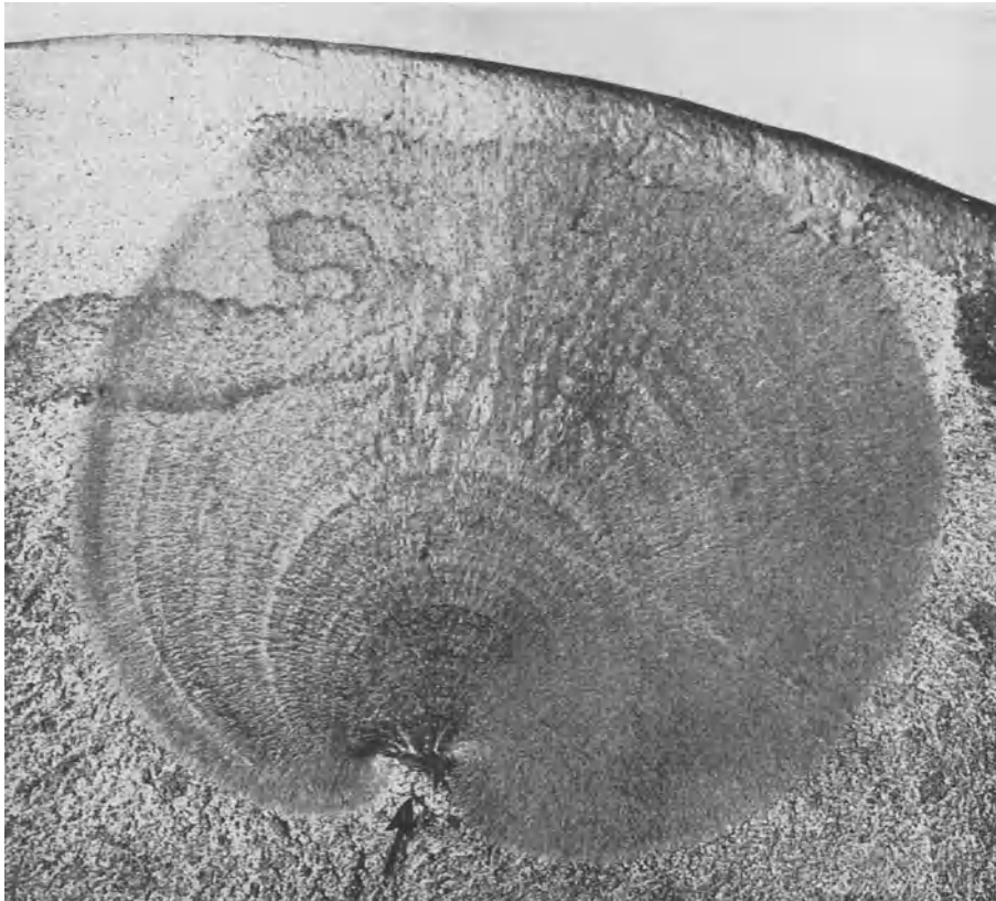
Fig. 223. Dauerbruch einer Feinblechwalze, x 1.
