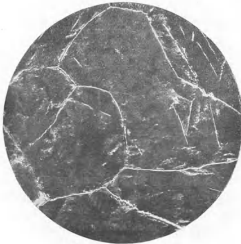
Fig. 24. Eisen-Kohlenstoff-Legierung mit 1,5% C, Ätzung II, x 100.
