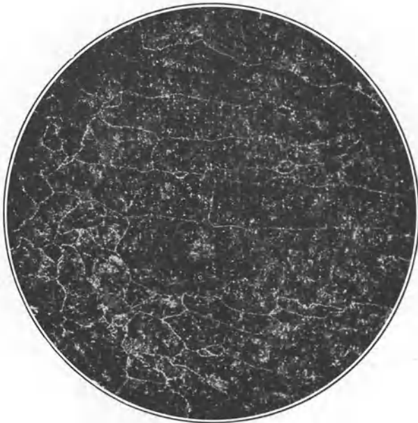
Fig. 158. Stahlguß mit 0,46% C, Ferrit in Zellen, Ätzung II, x 5.
