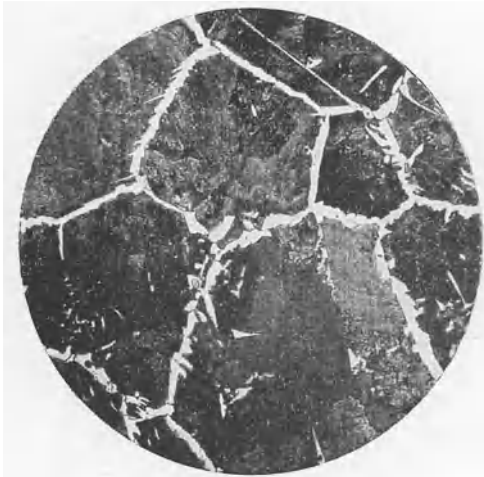
Fig. 281. Stahl mit 0,45% C bei 1250° geglüht, beginnende Überhitzung. Ätzung II, x 100.
