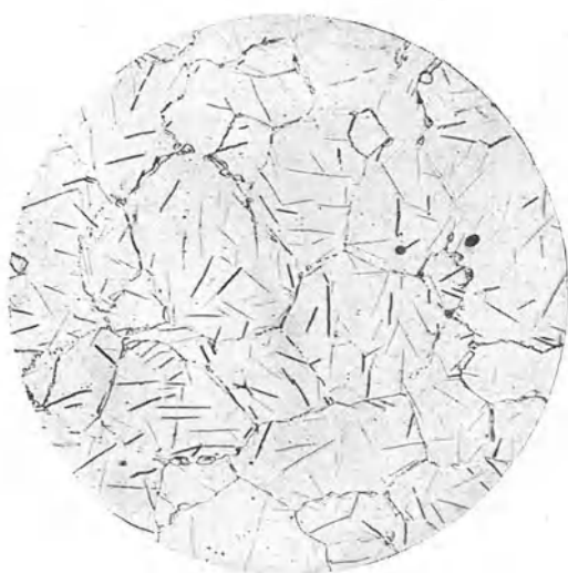
Fig. 89. Eisen-Stickstoff-Legierung mit geringem Stickstoffgehalt, Ätzung II, \times 100 .
