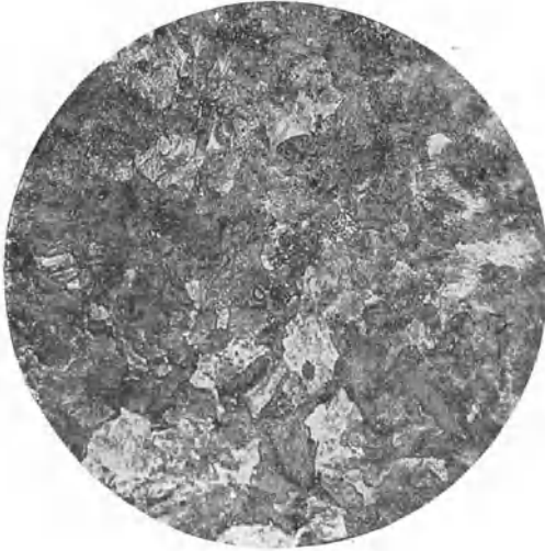
Fig. 289. Stahl mit 0,9% C bei 800° geglüht, Perlitkorn fein. Ätzung II. x 100.
