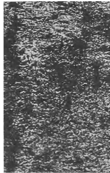
Fig. 313. Wie Fig. 310, jedoch angelassen auf 750° (Maurer), Ätzung II, x 400.
