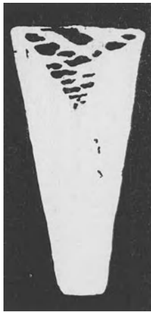
Fig. 168. Wachsblock in eine nach oben verbreiterte Form gegossen. (Howe und Stoughton.)
