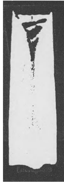
Fig. 171. Aus der gleichen Charge wie Fig. 170 gegossener Block, jedoch nicht komprimiert. (Heyn und Bauer.)
