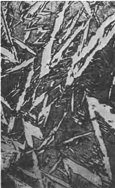
Fig. 315. Stahl mit 1,66\% C bei 1050^{\circ} abgeschreckt, \frac{2}{3} Austenit, \frac{1}{3} Martensit (Maurer), Ätzung II, \times 400 .
