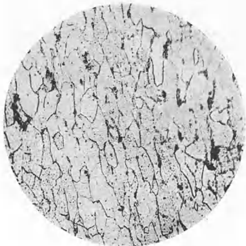
Fig. 217. Gedrückte Zone eines um 180° gebogenen Stabes aus weichem Flußeisen, Ätzung II, x 100.
