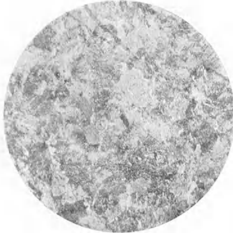
Fig. 23. Eisen-Kohlenstoff-Legierung mit 0,9% C, Ätzung II, x 100.
