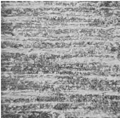
Fig. 296. Kesselblech im Anlieferungszustande, Ätzung I, x 50.
