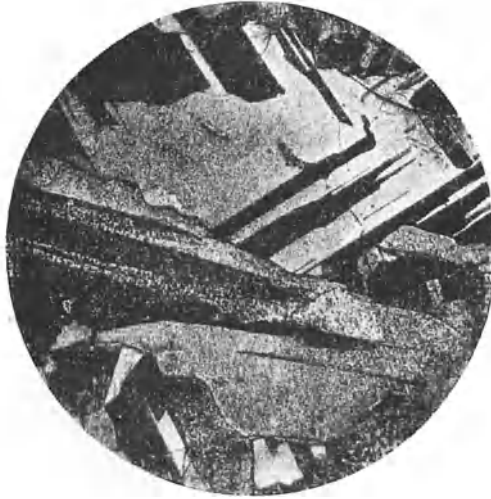
Fig. 15. Bei 1000° in Chlorkalzium heißgeätztes Elektrolyteisen. ( \gamma -Eisen.)
