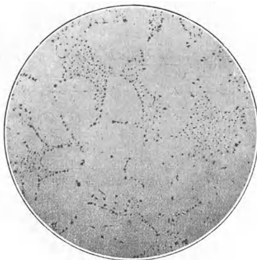
Fig. 97. Eutektisch angeordnete Einschlüsse in mit Mangan desoxydiertem, sauerstoffhaltigen Eisen, ungeätzt, \times 50 .
