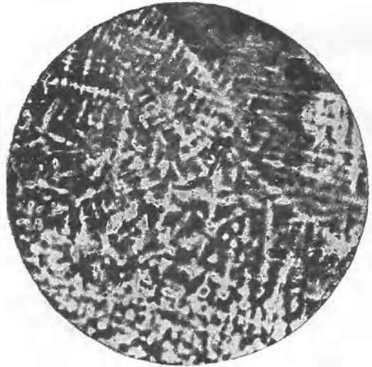
Fig. 43. Schichtkristalle in einer Eisen-Phosphor-Legierung mit 0,8% P, Ätzung I, x 4.
