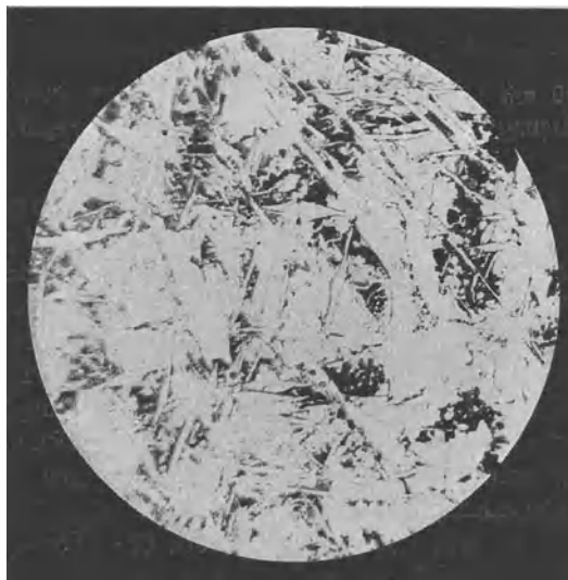
Fig. 194. Stahlguß mit 0.27% C, bei 800° geglüht, Ätzung II, x 80.
