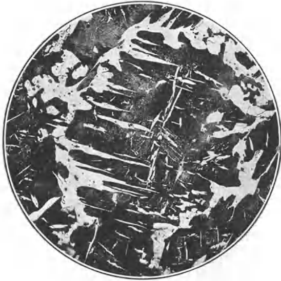
Fig. 199. Stahlguß mit 0,4% C, ungeglüht, Ätzung II, x 100.
