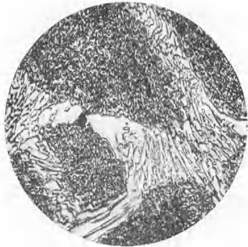
Fig. 74. Chromstahl aus dem Doppelkarbidfeld: etwa 1% Kohlenstoff, 15% Chrom; nicht geschmiedet. Ätzung II, x 900.
