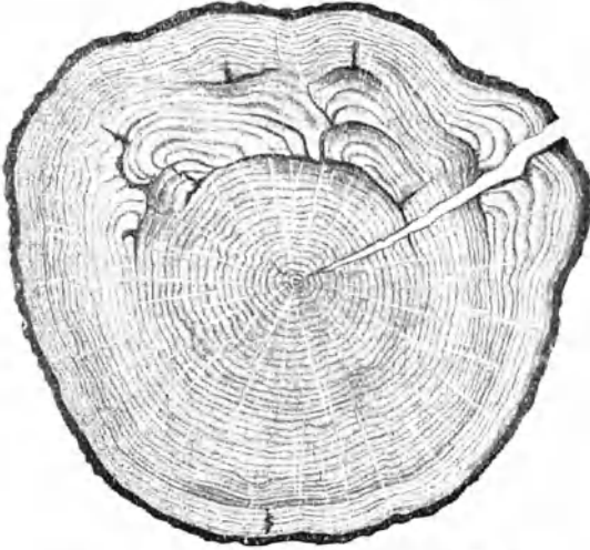
Abb. 40. Blühsuren an einer Eichenstammscheibe.
