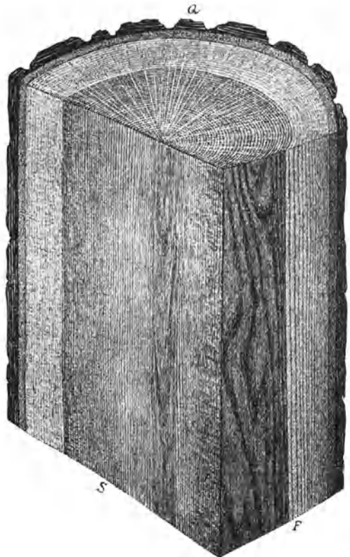
Abb. 2. Darstellung der drei Hauptschnittrichtungen an einem Ulmenstammstück.
