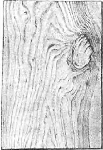
Abb. 38. Stück eines Lärchbrettes mit überwalltem, wundfaulem Ast.
