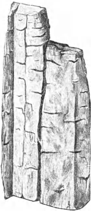
Abb. 53. Stück eines Türstodes durch den echten Hauschwamm ( Merulius lacrymans ) vollständig zerstört.
