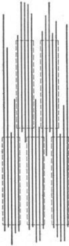
Abb. 31. Schematische Darstellung des möglichen Übergreifens der Hauptvalenzketten von einem Kristallit in den anderen. — Hauptvalenzkette, - - - - ungestörter Gitterbereich. Nach FREY-WYSSLING.
