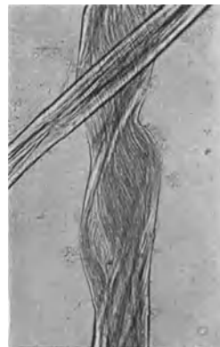
Abb. 21. Ramiefaser mit deutlicher Fibrillärstruktur. Vergr. 100×. Nach A. HERZOG.
