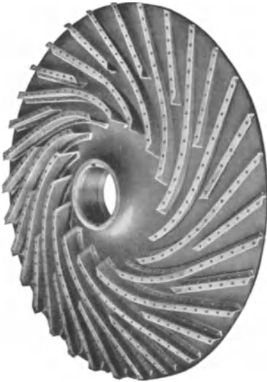
Abb. 159. Laufrad mit abgenommener Deckscheibe, Bauart Demag.
