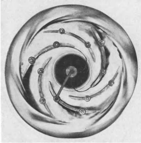
Abb. 35. Laufradströmung durch Farbstrahlen sichtbar gemacht. (Nach Thoma.)
