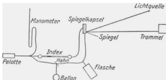
Abb. 284. Schema des Anschlusses der beidseitig gleich belasteten Spiegelsegmentkapsel an das Bolometer. (Nach SAHLI.)
