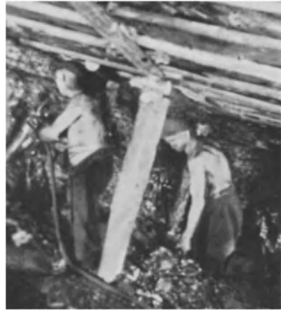
Abb. 29. Aufnahme unter Tage. Flöz noch verhältnismäßig hoch, da der Bergmann sich in kniender Stellung aufrichten kann. Trotzdem erkennt man, daß er die ganze Schicht in kniender Stellung arbeiten muß. Der links auf dem Bild sichtbare und den Abbauhammer bedienende Bergmann hält das linke Kniegelenk in einer besonders gefährdeten Stellung (vgl. Abb. 16 und 17 aus MOLIER!).
