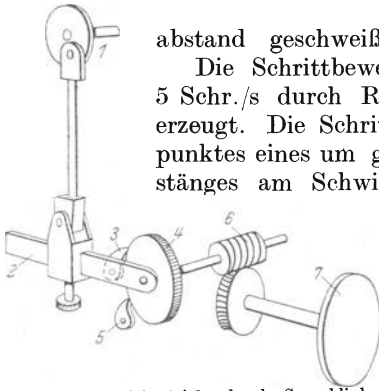
Abb. 84. Schrittantrieb durch Sperrklinke (bis zu 5 Schritte/s).
