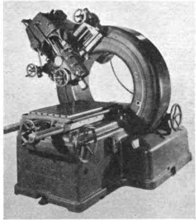
Abb. 50. Feinbohrwerk, gut geeignet zum Bohren von Vorrichtungskörpern. (Herbert Lindner, Berlin.)
