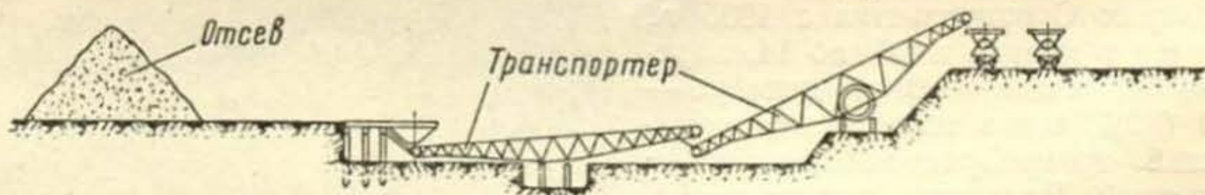
Фиг. 18. Ленточные транспортеры в сопряжении с малой механизацией
