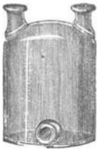
Abb. 88. Moderne Woulfe'sche Flasche mit zwei Hälsen u. Tubulus am Boden.
