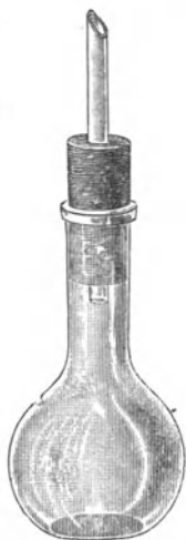
Fig. 125. Kölbchen zur Bestimmung der Verseifungszahl ätherischer Öle.
