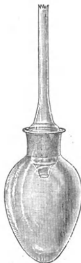
Fig. 126. Kölbchen zur quantitativen Azetylierung ätherischer Öle.
