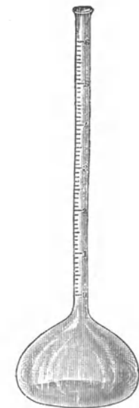
Fig. 127. Kölbchen zur Bestimmung des Zitralgehaltes ätherischer Öle.
