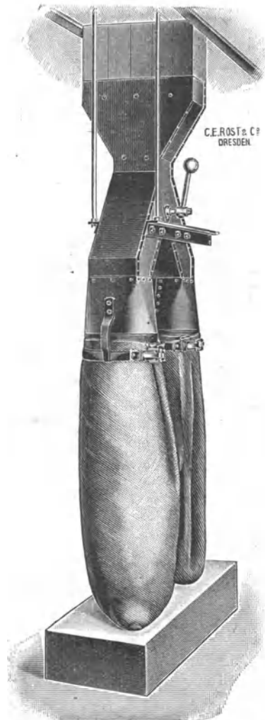
Fig. 111. Absackvorrichtung für Seifenpulver.
