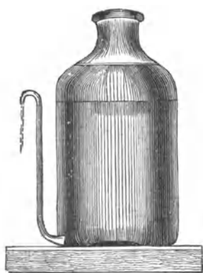
Fig. 118. Flasche zur Trennung von Flüssigkeiten von verschiedenen spezifischen Gewichten.
