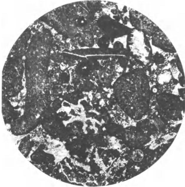
Abb. 12. Dünnschliff von Kalkstein. Sedimentgestein, besteht nur aus verkitteten Muschelschalen und Korallen (reiner kohlensaurer Kalk, \text{CaCO}_3 ).
