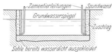
Abb. 140b. Zementieren der Seitenwand.
