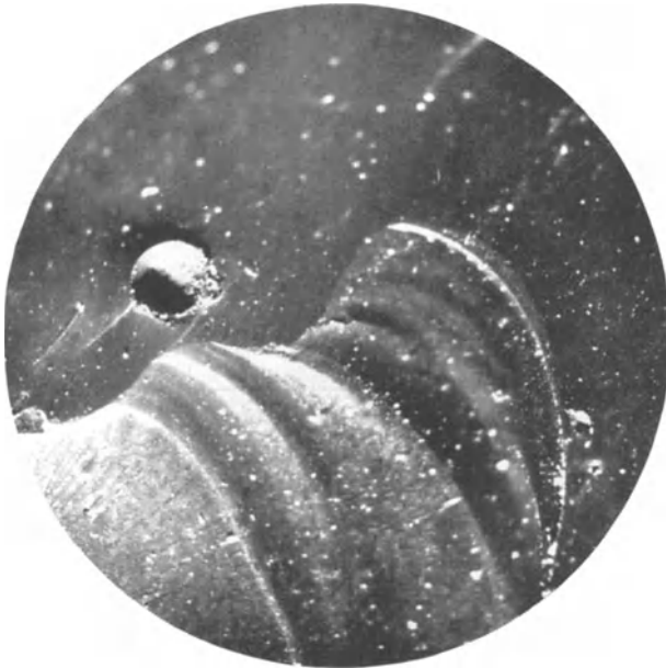
Abb. 18. Oberfläche von glasigem Zuschlag (nichtgetemperte Manfelder Schlacke). Das amorphe Gefüge des Zuschlags führt zu dem glatten Bruch. Der Zement haftet schlecht an dieser glasigen Oberfläche. Folge: geringe Biegefestigkeit.
