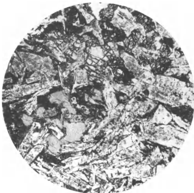
Abb. 7. Dünnschliff von Diabas. Gemengtes Gestein, bestehend aus Feldspat, Augit, Chlorit und Magneteisen. Alle Mineralien sind schon leicht verwittert, der Diabas aber noch brauchbar.
