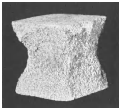
Abb. 175. Normenkörper ordnungsgemäß gedrückt.
