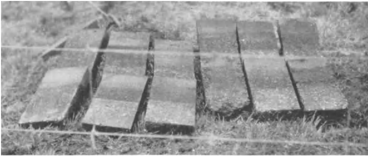
Abb. 233. Platten aus einem Moor, hergestellt im Mischungsverhältnis 1 : 3 und 1 : 6 aus Portlandzement, Eisenportland- und Hochofenzement mit beginnender Zerstörung.
