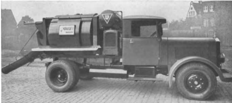
Abb. 94. Transportwagen für den auf Mischanlage Abb. 92 hergestellten Transportbeton: Der Betonbehälter dreht sich während der Fahrt, um Entmischung und Abbinden zu verhindern.
