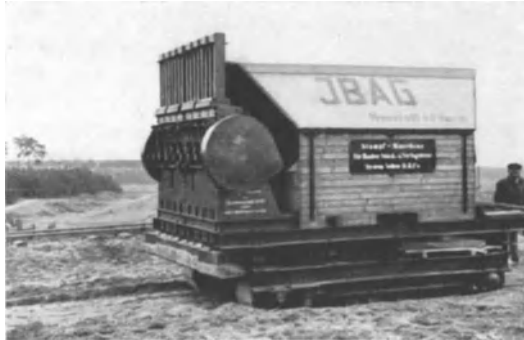
Abb. 107. Stampfmaschine nach Velten. Die Maschine arbeitet mit sehr schweren Stampfern zur Verdichtung von Erdreich und Beton.
