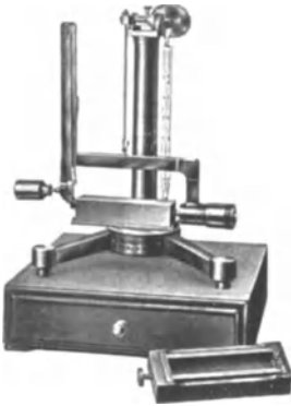
Abb. 37. Apparat nach Bauschinger zur Messung von 10 cm langen Mörtelprismen auf Schwindung. Die Prismen werden in den Apparat eingesetzt und ein Tasthebel mißt die Längenänderung.
