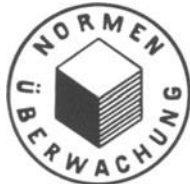
Abb. 31. Das Normenüberwachungszeichen, welches alle Zemente auf den Säcken tragen müssen, die von den zuständigen Laboratorien regelmäßig überwacht werden. Zemente ohne dieses Zeichen dürfen bei Bauten, die einer baupolizeilichen oder sonstigen behördlichen Genehmigung bedürfen, nicht zur Herstellung von Beton, Eisenbeton oder Steineisendecken verwendet werden. Vgl. Deutsche Normen für Portlandzement, Eisenportland- und Hochofenzement, DIN 1045, DIN 1046, DIN 1048, DIN 1164.
