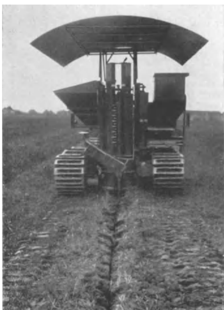
Abb. 148. Pflug zur Herstellung des Rohres von Abb. 147.
