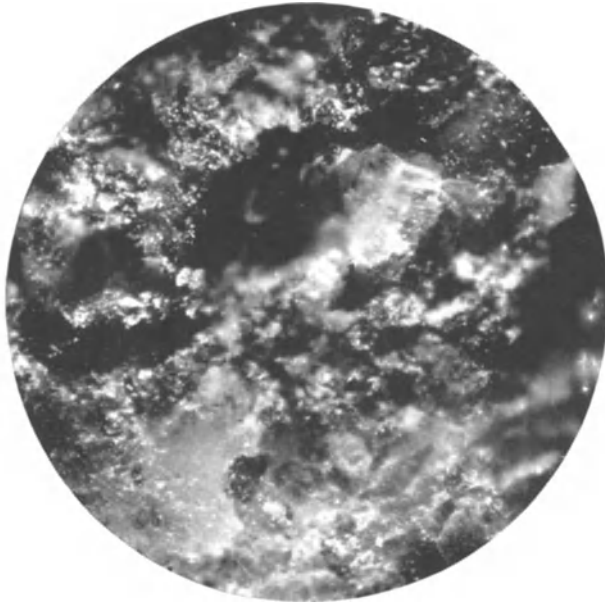
Abb. 19. Oberfläche von Granit bei 20facher Vergrößerung, körnig-kieseliges Gefüge. Die rauhe durch das körnige Gefüge hervorgerufene und deshalb im Beton gut anbindende Oberfläche ist deutlich zu sehen.
