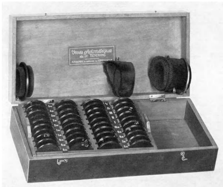
Abb. 82. Der große Photoptriebrillenkasten von TSCHERNING. Der Kasten enthält zwei Reihen nach Photoptrien abgestufte Gläser. Auf den inneren Rahmen des Deckels wurden vor der Photographie die mit einer weichen Umrandung versehenen ringförmigen Fassungen aufgesetzt, in welche die Gläser eingepaßt werden. Wegen der weichen Umrandung ermöglichen sie einen lichtdichten Abschluß des Auges.
