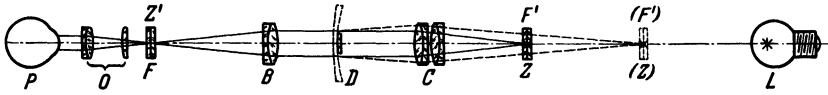
Abb. 19b. Ein Achsenschnitt durch die Linsenfolge eines ZEISS'schen Scheitelbrechwertmessers mit dem Strahlengang. (Abweichend von den anderen Bildern gibt dieses die Lichtrichtung von rechts nach links.)
