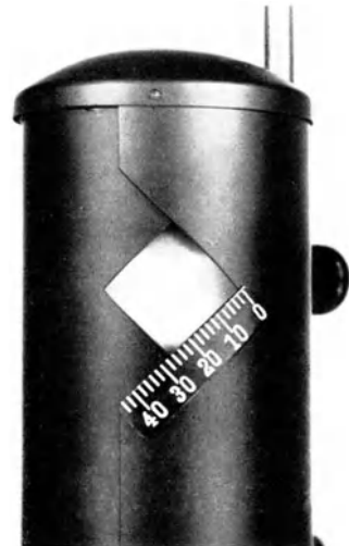
Abb. 56. Lampe für augenärztliche Untersuchungen mit AUBERTScher Blende vor einer Milchglasbirne, die annähernd gleichmäßige Leuchtdichte im mittleren Gebiet ihrer Oberfläche aufweist. (Zum Augenspiegeln, zur abgestuften Belichtung von Sehproben und zur schnellen Orientierung über die Leistung des Lichtsinns.)
