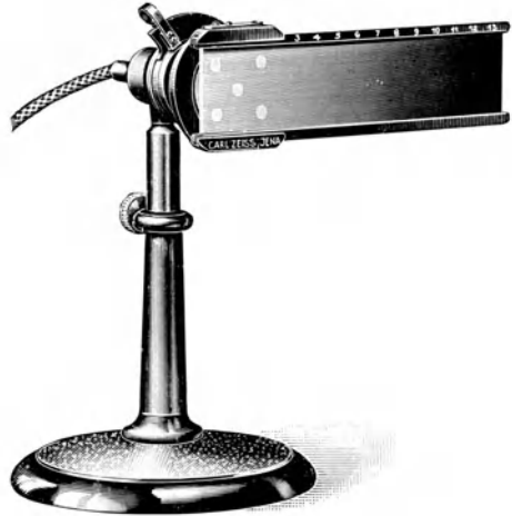
Abb. 78. Fünfpunktadaptometer nach BIRCH-HIRSCHFELD. Man sieht hinter dem relativ durchlässigen Ende des Grauglaskeils die 5 Punkte, welche von hinten her beleuchtet werden. Die Beleuchtung läßt sich durch eine Irisblende noch weiter abstimmen.
