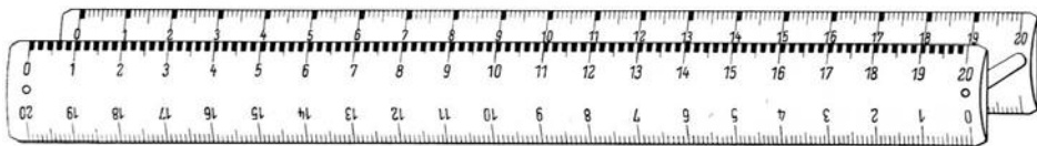
Abb. 12. Doppellineal nach LANDOLT zur Messung des Pupillenabstandes.
