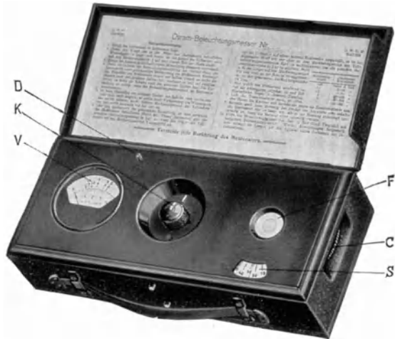
Abb. 62. Moderner deutscher Beleuchtungsmesser der Firma Osram. F Voltmesser, K Knopf zum Einstellen der Voltzahl, F Felder zur Messung der Beleuchtung: ein Umfeld, welches aus einer gut diffus reflektierenden Fläche besteht, und ein Infeld, welches von hinten her durch die unter konstanter Voltzahl gehaltene Birne einer Taschenlampe beleuchtet wird. C Zahnrad zum Einstellen der Leuchtdichte des Infeldes. Die entsprechende Beleuchtung kann man auf der Skala S ablesen.
