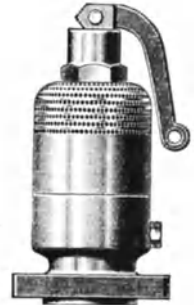
Abb. 124. Popple'sches Sicherheitsventil mit verstellbarem Vollhub für Lokomotiven.
