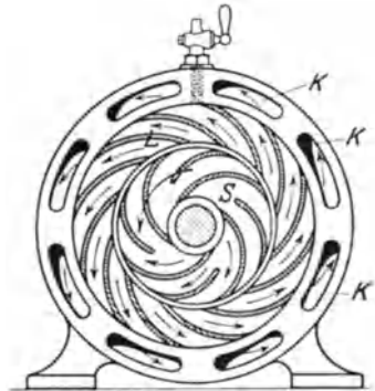
Abb. 136. Querschnitt durch eine Kreiselpumpe.
