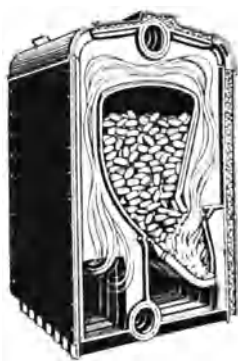
Abb. 161. Lollarkessel der Buderusschen Eisenwerke, Weßlar, für Brickettfeuerung mit unterem Abbrand.
