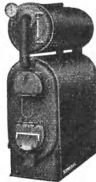
Abb. 157. Fertiger Strebelkessel mit Dampfhammer.
