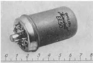
Abb. 99. Pentode zur Spannungsverstärkung im Rundfunk- und im Kurzwellengebiet bis etwa 4 m Wellenlänge herab mit Stahlhülle und allen Elektroden- (auch Steuergitter-) Anschlüssen am Boden. Rechts: Zentimeterskala.
