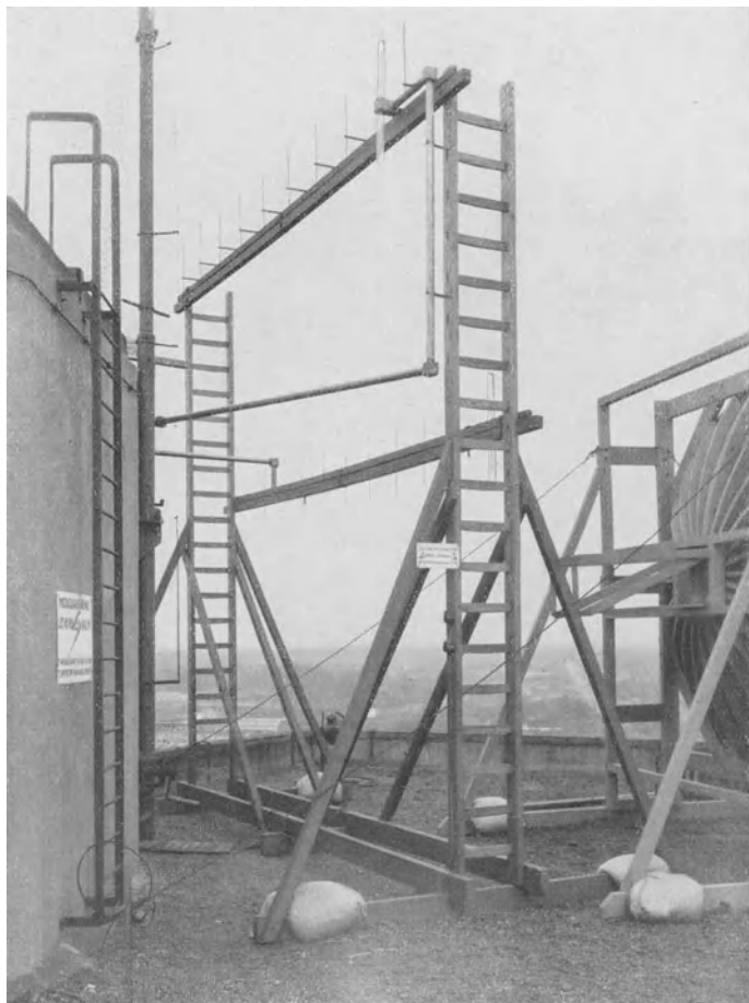
Abb. 22. Anordnung zweier Wellenleiter nach Abb. 20 für Sende- und Empfangszwecke. Die letzten drei Abbildungen aus Philips techn. Rundschau Bd. 2 (1937).
