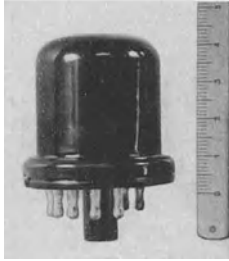
Abb. 99. Pentode zur Spannungsverstärkung im Rundfunk- und im Kurzwellengebiet bis etwa 4 m Wellenlänge herab mit Stahlhülle und allen Elektroden- (auch Steuergitter-) Anschlüssen am Boden. Rechts: Zentimeterskala.
