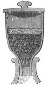
Durchschnittszeichnung eines beschickten Deplacirtrichters aus Steingutmasse.
