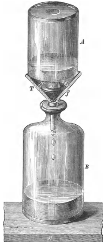
Filtrirmethode für flüchtige Flüssigkeiten. Der Trichter T mit kleinem Filter f wird über die Flasche A (mit der zu filtrirenden Flüssigkeit) gestülpt, dann das Ganze in fester Aneinanderlage schnell umgekehrt und mit dem Trichter C auf eine andere Flasche B gesetzt. Die Kante des Flaschenhalses darf dem Filter nicht dicht anliegen.
