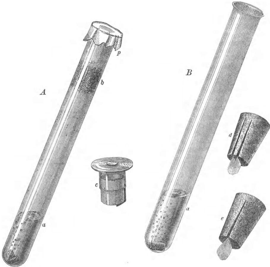
Vorrichtung der Prüfung der Salzsäure auf Schwefligsäure und Arsenigsäure nach HAGER. a Salzsäure mit Wasser verdünnt und einige Zinkstückchen. d zweimal gespaltener Kork mit zwei Streifen Papier, das abgerundete mit Bleiessig, das zugespitzte mit Silbernitratlösung bestrichen. e ein einmal gespaltener Kork nur mit einem Papierstreifen versehen
