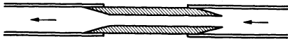
Abb. 9. Dünnwandiges Weichgummirohr. In der Mitte Hartgummirohr mit entsprechend abgefleiten Enden. Stromrichtung analog der Aorteninsuffizienz.
