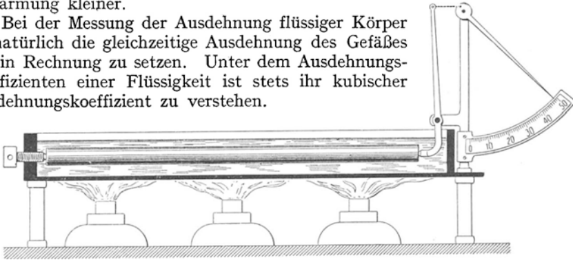
Abb. 162. Längenänderung eines Stabes durch die Wärme.
