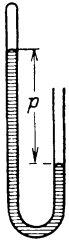
Abb. 98. Abgekürztes Quecksilberbarometer. Die Öffnung ist mit dem Raum verbunden zu denken, in dem der Druck gemessen werden soll.
