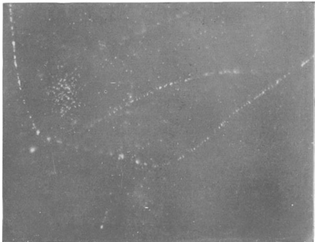
Abb. 313. Bahnen von Elektronen, mit der Nebelmethode sichtbar gemacht.
