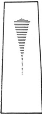
Fig. 9. Schema der Seigerung in einem Flußeisenblock.
