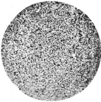
Fig. 70. Zementiertes Eisen, Kernzone. V = 68 .
