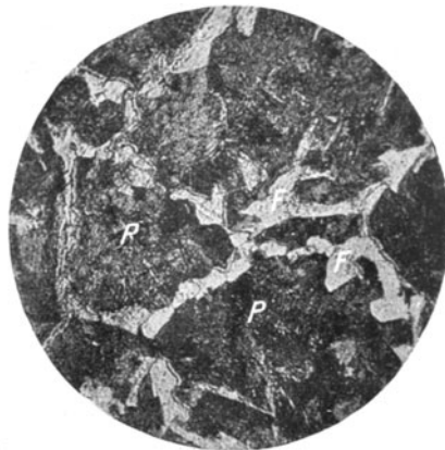
Fig. 53.* Stahlguß mit 0,4 % Kohlenstoffgehalt. V = 250 .
