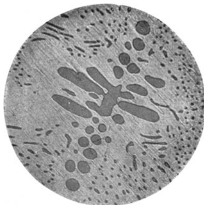
Fig. 115. Kupfer mit Kupferoxyd-einschlüssen. V = 100 .
