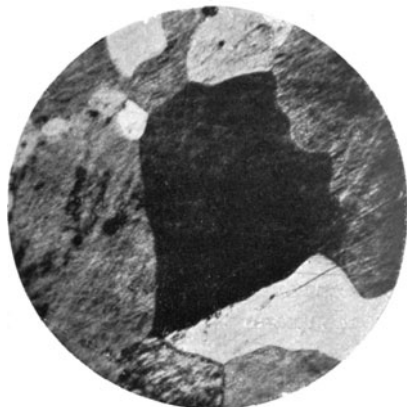
Fig. 80. Das gleiche Fluß Eisen wie Fig. 79 nach 36 stündigem Glühen. V = 67 .
