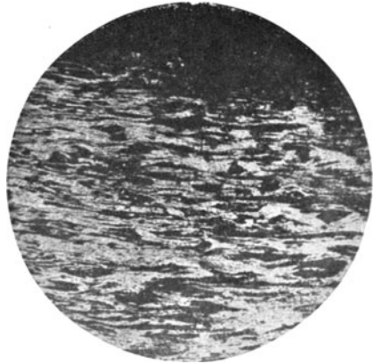
Fig. 96*. Eisenbahnradreifen, Verzerrung der Kristalle an der Lauffläche des Reifens. V = 94 .
