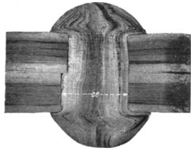
Fig. 32. Nietung, Schweißisenblech und Schweißeisenniet.
