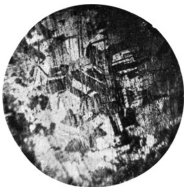
Fig. 112. Kupferdraht. Handelsware. V = 100 .
