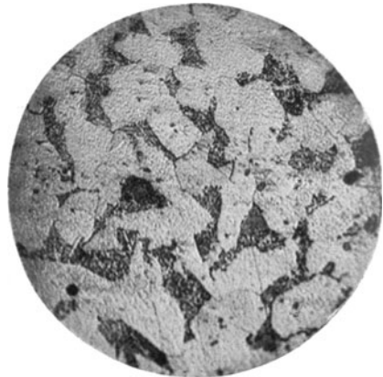
Fig. 44. Kohlenstoffarmes Eisen, langsam abgekühlt. Gefüge: Ferrit und Perlit. V = 350 .
