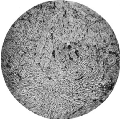
Fig. 42. Kohlenstoffarmes Eisen bei 1000° C abgeschreckt. Gefüge: Martensit. V = 350^* ).
