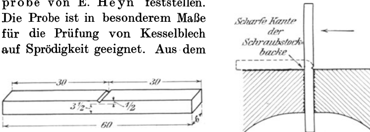
Fig. 22* u. Fig. 23*. Kerbschlagbiegeprobe nach E. Heyn.
