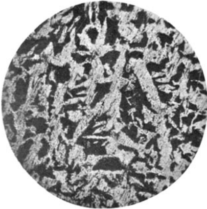
Fig. 95*. Eisenbahnradreifen, normales Gefüge. V = 94 .
