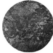
Fig. 111*. Derselbe Kupferdraht wie Fig. 110, jedoch gegläht. V = 100 .
