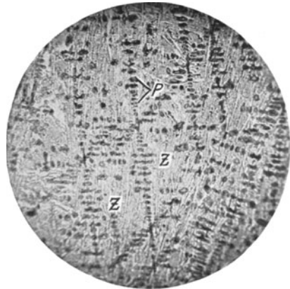
Fig. 60. Hartguß, abgeschreckte Stelle. V = 52 .
