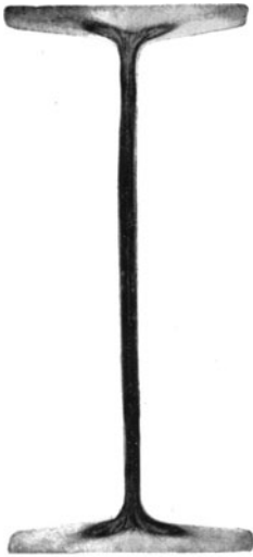
Fig. 15. I-Flußeisen mit starker Seigerung.
