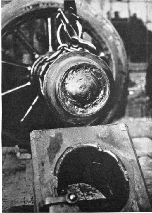
Fig. 109*. Durch Warmlauf gebrochene Lokomotivachse.
