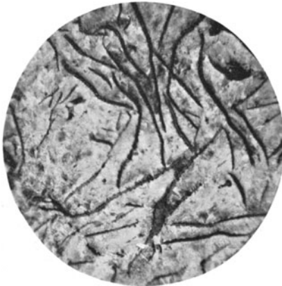
Fig. 56. Graues Gueisen. V = 66 .
