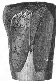
Fig. 257. Whitworth's Stahlgeschosß nach dem Schuß.
