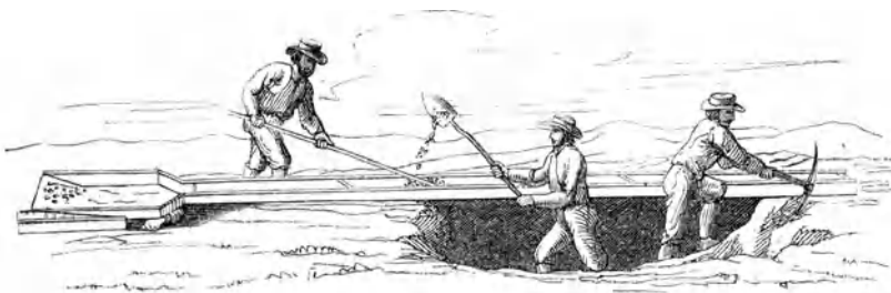
Fig. 89. Goldgewinnung aus Gruben mittels Wasserleitung und Sieb.
