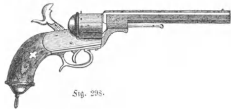
Fig. 296 bis 298. Vefaucheur-Revolver der französischen Marine. Patrone, Schloß und Revolver.
