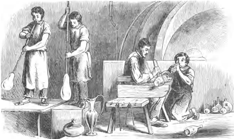
Fig. 198. Arbeit auf dem Stuhle mit der Zwickerschere.
