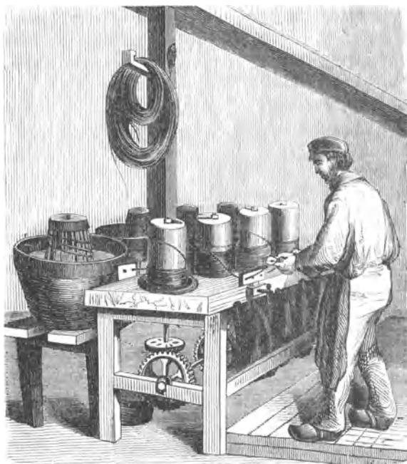
Fig. 36. Arbeit an der Scheibenziehbank.
