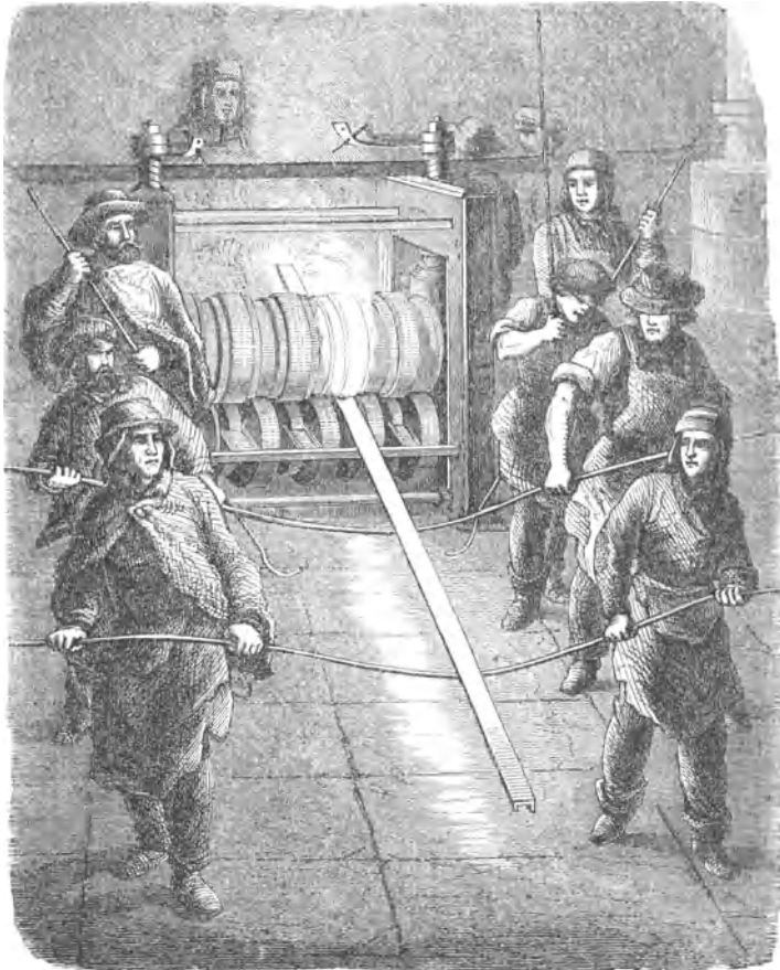
Sig. 31. Auswalzen der Eisenbahnschienen.
