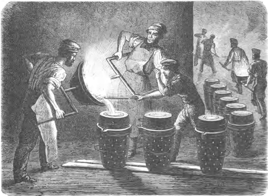
Fig. 21. Guß von 100pfündigen Kanonentugeln im Arsenal zu Woolwich.
