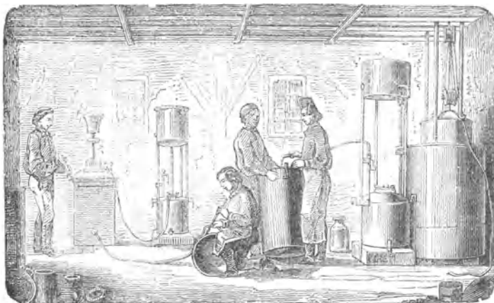
Fig. 61. Zusammenlöthen der Bleiegefäße mittels Wasserstoffgas.
