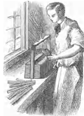
Fig. 326. Eintesen der Hölzchen in den Rahmen.
