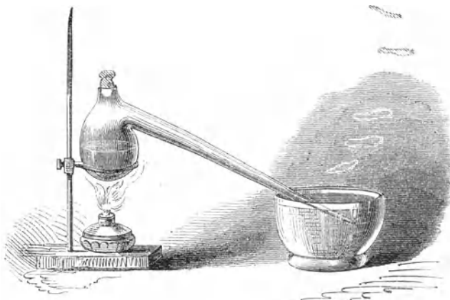
Fig. 320. Entwicklung von Phosphorwasserstoff.
