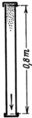
Abb. 79. Einfaches Verfahren zur Bestimmung der bei der Vernichtung von Energie erzeugten Wärme.
